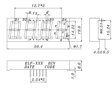
COMMON CATHODE 1 ANODE E ANODE DANODE DP 3 4 ANODE CANODE G5 6 COMMON CATHODE D4 ANODE B8 COMMON CATHODE D3 9 COMMON CATHODE D2 10 ANODE F 11 ANODE A 12 COMMON CATHODE D1
