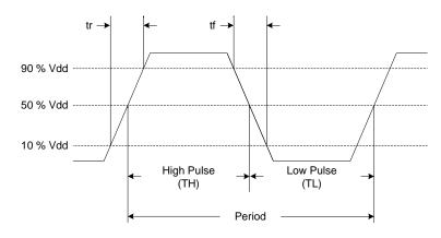
Figure 15. LVCMOS Waveform Diagram<sup>[11]</sup>
