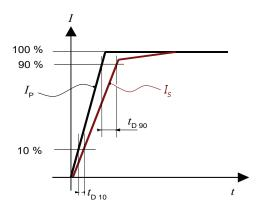
Figure 6:  $t_{\rm D~10}$  (delay time @ 10 %) and  $t_{\rm D~90}$  (delay time @ 90 %)
