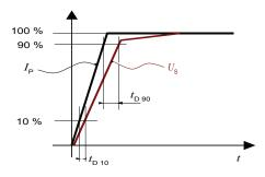
$t_{\rm D\,10}$  (delay time @ 10 %) and  $t_{\rm D\,90}$  (delay time @ 90 %)
